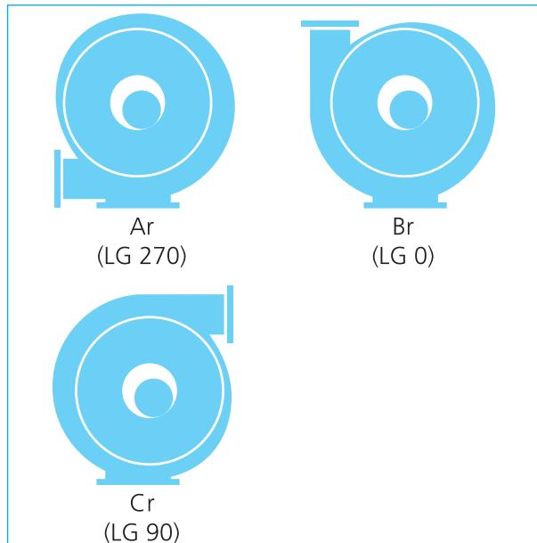
In der Standardausführung erfolgt die Lieferung, mit der Klemmenkastenlage 270° (oben) und Kabeleinführung A (rechts). Erläuterungen zur Klemmenkastenlage und den Kabeleinführungsvarianten siehe Seite 14.
