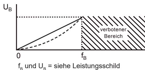
Bei Nichtbeachtung steigt der Motorstrom überproportional an und der Antriebsmotor kommt nicht auf Bemessungsdrehzahl.
