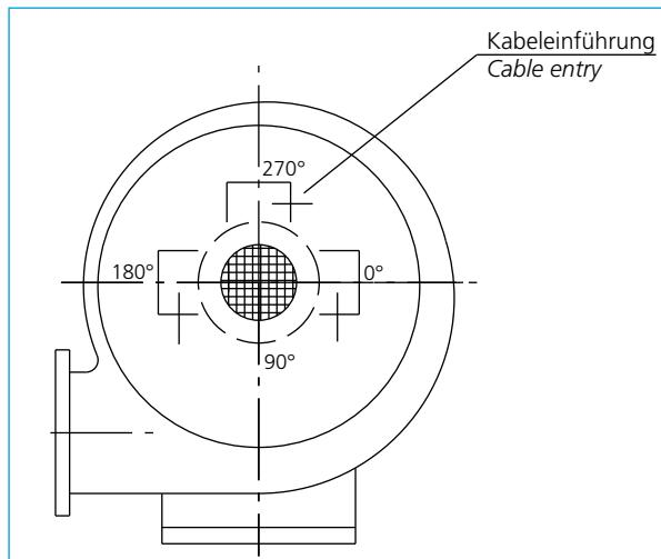
**Definition der Klemmenkastenlage
