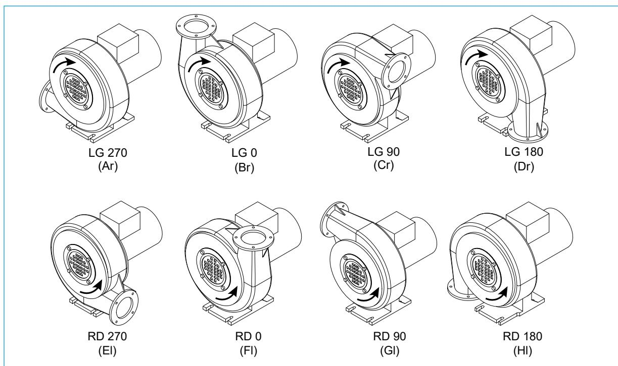
In der Standardausführung erfolgt die Lieferung, mit der Klemmenkastenlage 270° (oben) und Kableinführung A (rechts). Erläuterungen zur Klemmenkastenlage und den Kableinführungsvarianten siehe Seite 13.
